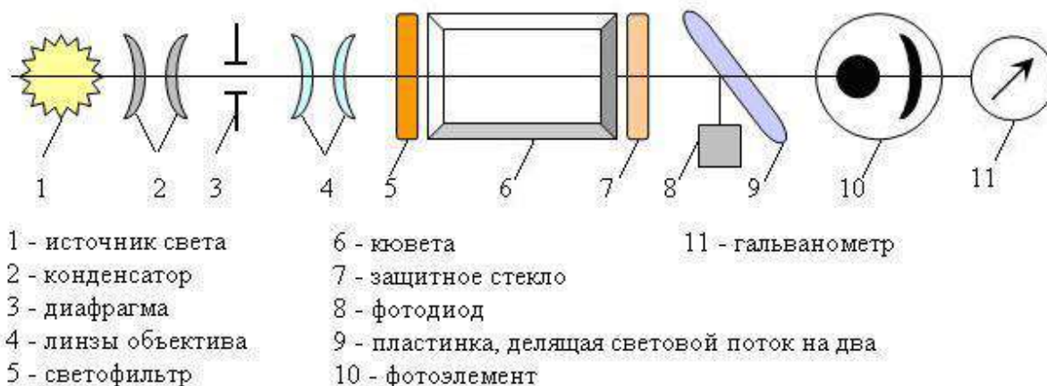
Рис. 11. Оптическая схема фотоэлектроколориметра КФК-2
