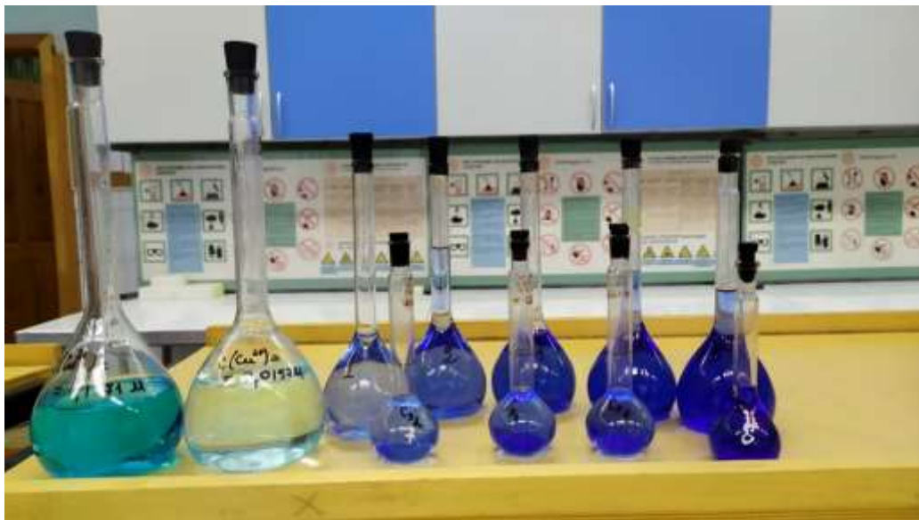
Рис. 16. Растворы солей меди (II) (слева направо): в колбах на 250 см 3 стандартный раствор I ( C(\text{Cu}^{2+})=0,1571\text{M} ), стандартный раствор II ( C(\text{Cu}^{2+})=0,0157\text{M} ), в колбах на 50 см 3 – растворы калибровочной шкалы (1 – 5), в колбах на 25 см 3 – контрольные задачи C_{x1} - C_{x4}
